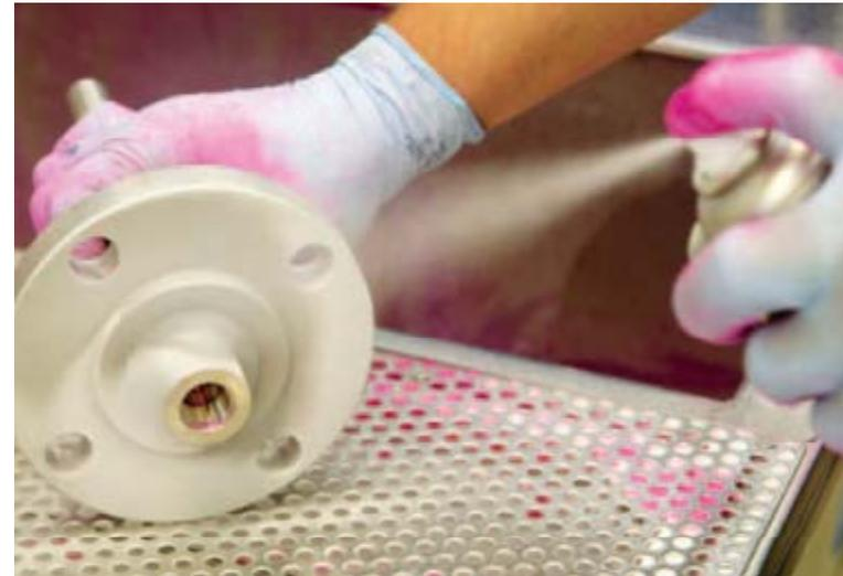
Ejemplo: Prueba de penetración con colorante en termopozo/vaina; aplicando revelador
